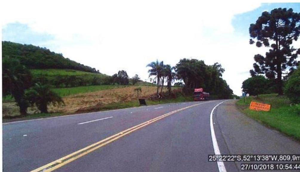
Figura 36: Placa instalada desnivelada, desuniforme e com a mensagem parcialmente encoberta: BR-277, Sentido decrescente, km 433+040.
