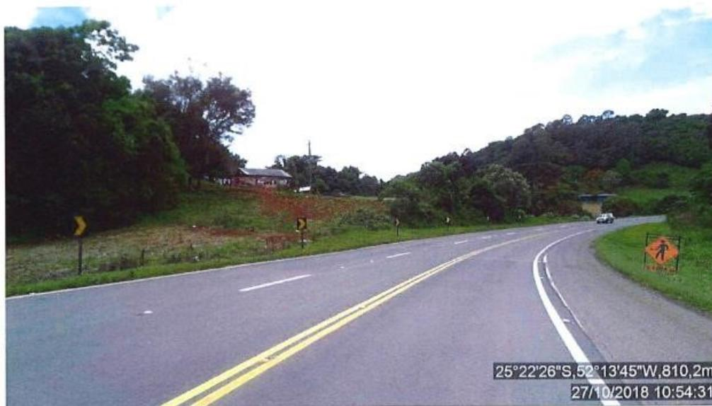
Figura 37: Placa instalada desnivelada, desuniforme e com a mensagem parcialmente encoberta: BR-277, Sentido decrescente, km 433+280.
