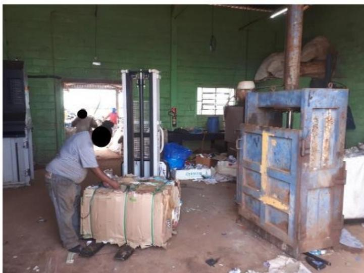
**Figura 7 – Prensa compactadora e operação de enfardamento (detalhe da atividade em execução).**
